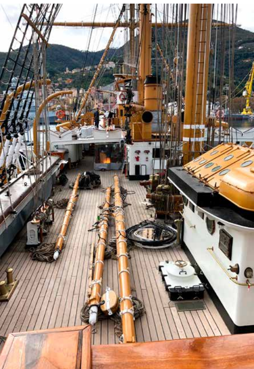
Alcune fasi dell'importante lavoro di manutenzione svolto su Nave Vespucci lo scorso anno, dalla revisione completa degli alberi (a sinistra) al rifacimento delle vele (qui sopra) tutto effettuato da maestranze specializzate con anni di esperienza sulle spalle
