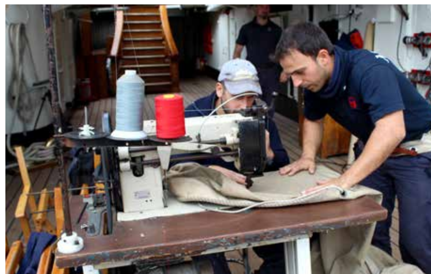
Alcune fasi dell'importante lavoro di manutenzione svolto su Nave Vespucci lo scorso anno, dalla revisione completa degli alberi (a sinistra) al rifacimento delle vele (qui sopra) tutto effettuato da maestranze specializzate con anni di esperienza sulle spalle
